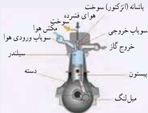
شکل ۵-۲۰ طرحی از اجزای یک ماشین دیزل
