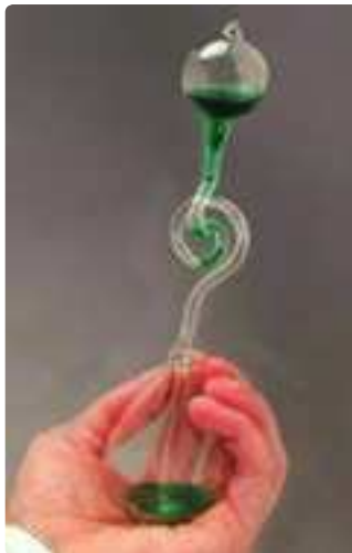
شکل ۴-۳۸ با در دست گرفتن حباب شیشه‌ای و گرم کردن آن، مایع رنگی در لوله ماریچج بالا می‌رود.
