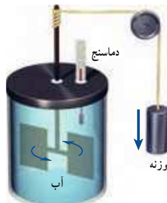
شکل ۱۵-۴ نمونه‌ای از آزمایش ژول: در این آزمایش نشان داده می‌شود کار نیروی وزن برابر با مقدار گرمای لازم برای افزایش دمای آب است.
