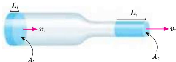
**شکل ۲-۲۶** در یک شاره تراکم‌ناپذیر، مقدار شاره‌ای که در بازه زمانی  $\Delta t$  از سطح مقطع  $A_1$  می‌گذرد درست برابر مقدار شاره‌ای است که در همین بازه زمانی از سطح مقطع  $A_2$  می‌گذرد.
