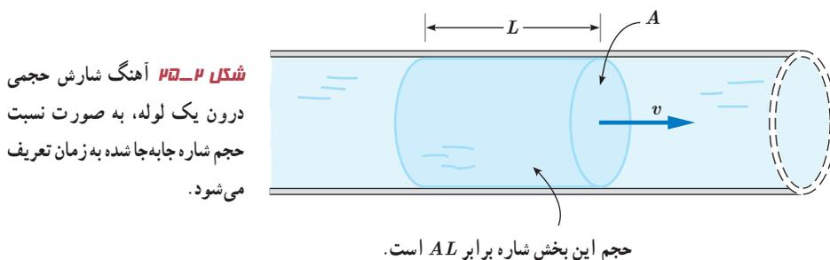
شکل ۲-۲۵ آهنگ شارش حجمی درون یک لوله، به صورت نسبت حجم شماره جابه‌جا شده به زمان تعریف می‌شود.
