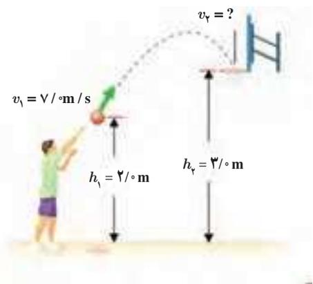
شکل روبه‌رو ورزشکاری را در حال یرتاپ توپ بسکتبالی با تندی  $v_1 = 7.0 \text{ m/s}$  به طرف سبد نشان می‌دهد. تندی توپ هنگام رسیدن به دهانه سبد چقدر است؟ مقاومت هوا را هنگام حرکت توپ نادیده بگیرید.
