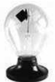
پرتوسنج (رادیومتر) وسیله‌ای است که از یک حباب شیشه‌ای تشکیل شده است که درون آن چهار پره فلزی قائم قرار دارد که می‌توانند حول یک محور (سوزن عمودی) بچرخند. دو وجه هر چهار پره، یک در میان سفید و سیاه است. وقتی این وسیله کنار یک چشمه نور قرار گیرد، پره‌ها حول سوزن عمودی می‌چرخند و هر چه شدت نور بیشتر باشد، این چرخش سریع‌تر است. در مورد دلیل چرخش پره‌ها تحقیق کنید.
