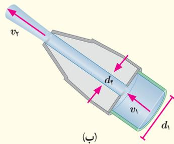
شکل (الف) آتش‌نشانی را در حال خاموش کردن آتش از فاصله نسبتاً دوری نشان می‌دهد. نمایی بزرگ‌شده از شیر بسته‌شده به انتهای لوله آتش‌نشانی در شکل (ب) نشان داده
