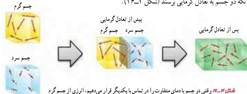
**شکل ۱۶-۴** وقتی دو جسم با دمای متفاوت را در تماس با یکدیگر قرار می‌دهیم، انرژی از جسم گرم به جسم سرد، منتقل می‌شود. با رسیدن به تعادل گرمایی، دیگر گرمایی منتقل نمی‌شود.
