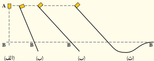
شکل روبه‌رو، چهار وضعیت متفاوت را برای حرکت جسمی نشان می‌دهد. در وضعیت الف، جسم از حال سکون سقوط می‌کند و در سه وضعیت دیگر جسم از حال سکون روی مسیری بدون اصطکاک و رو به پایین حرکت می‌کند. تندی جسم را در نقطه B برای هر چهار وضعیت با هم مقایسه کنید.
