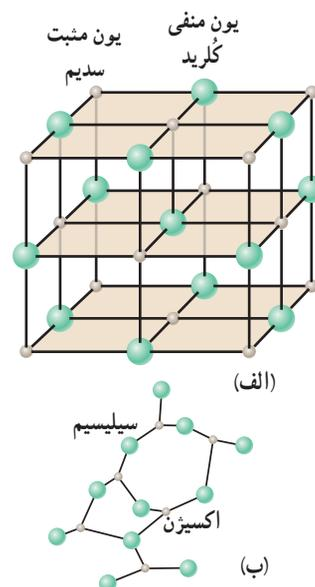
**شکل ۲-۳** الف) ساختار بلورین NaCl، که در آن یون‌های سدیم و یون‌های کلرید به صورت یک در میان در گوشه‌های یک مکعب قرار گرفته‌اند. ب) ذرات سازنده یک جامد بی‌شکل، مانند شیشه که در طرحی نامنظم در کنار هم قرار گرفته‌اند.
