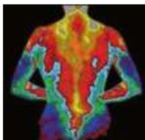
**شکل ۴-۳۳** تصویری دمانگاشت از بدن یک فرد. سطح بدن یک فرد معمولی در محیطی با دمای  $22^{\circ}\text{C}$  به دلیل تابش گرمایی با آهنگی در حدود  $10\text{ W}$  گرما از دست می‌دهد در حالی که در همین شرایط به دلیل همرفت و رسانش در هوای مجاور سطح بدن، در مجموع با آهنگی در حدود  $100\text{ W}$  گرما از دست می‌دهد.
