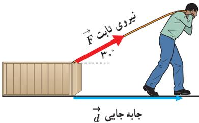
شکل روبه‌رو شخصی را نشان می‌دهد که جعبه‌ای را با نیروی ثابت  $200\text{ N}$  روی سطحی هموار و با اصطکاک ناچیز، به اندازه  $10\text{ m}$  جابه‌جا می‌کند.
