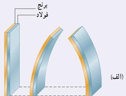
**شکل ۱۱-۴ الف** تیغه دوفلزه با تغییر دما در جهت‌های مختلفی خم می‌شود، (ب) دماپا در یک کتری برقی، (پ) با برقرار شدن جریان الکتریکی، نوار دوفلزه گرم می‌شود. (ت) سپس نوار خم شده و اتصال را قطع می‌کند.
