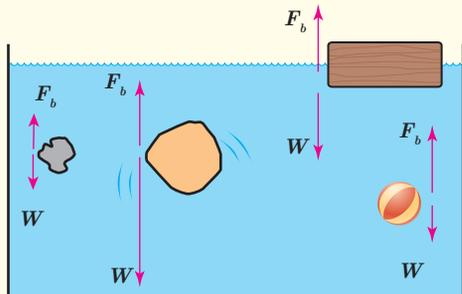
در شکل روبه‌رو، نیروی شناوری  $F_b$  و نیروی وزن  $W$  وارد بر چند جسم نشان داده شده است. با توجه به نیروی خالص وارد بر هر جسم، وضعیت آن را به کمک یکی از واژه‌های شناوری، غوطه‌وری، فرورفتن و بالارفتن توصیف کنید.
