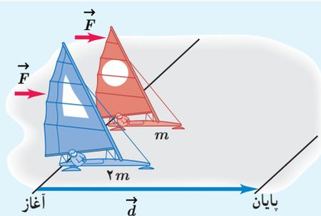
دو قایق بادبانی مخصوص حرکت روی سطوح یخ‌زده، دارای جرم‌های  $m$  و  $2m$ ، روی دریاچه افقی و بدون اصطکاک قرار دارند و نیروی ثابت و یکسان  $\vec{F}$  با وزیدن باد به هر دو وارد می‌شود (شکل روبه‌رو). هر دو قایق از حال سکون شروع به حرکت می‌کنند و از خط پایان به فاصله  $d$  می‌گذرند. انرژی جنبشی و تندی قایق‌ها را درست پس از عبور از خط پایان، با هم مقایسه کنید.
