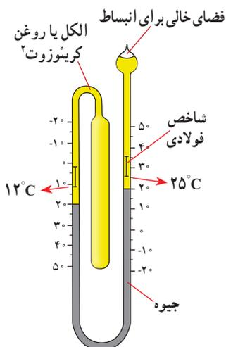
نوع ویژه‌ای از دماسنج‌های مایعی که بیشینه و کمینه دما را در یک مدت زمان معین نشان می‌دهد، دماسنج بیشینه - کمینه نام دارد. از این دماسنج‌ها معمولاً در مراکز پرورش گل و گیاه، باغداری، هواشناسی و ... استفاده می‌شود. در مورد چگونگی کار این دماسنج‌ها تحقیق کنید.
