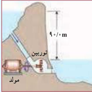
آب ذخیره شده در پشت سد یک نیروگاه برق آبی، از مسیری مطابق شکل روی پره های توربینی می‌ریزد و آن را می‌چرخاند. با چرخش توربین، مولد می‌چرخد و انرژی الکتریکی تولید می‌شود (شکل روبه رو). اگر ۸۵ درصد کار نیروی گرانش به انرژی الکتریکی تبدیل شود، در هر ثانیه چند متر مکعب آب باید روی توربین بریزد تا توان الکتریکی خروجی مولد نیروگاه به  $200\text{ MW}$  برسد؟ جرم هر متر مکعب آب را  $1000\text{ kg}$  در نظر بگیرید.
