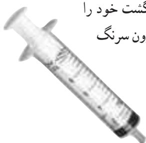
یک سرنگ، مثلاً  $10^\circ$  سی سی، اختیار کنید. پیستون آن را بکشید تا هوا وارد سرنگ شود. انگشت خود را محکم روی دهانه خروجی سرنگ قرار دهید و تا جایی که می‌توانید پیستون را حرکت دهید تا هوای درون سرنگ متراکم شود.
