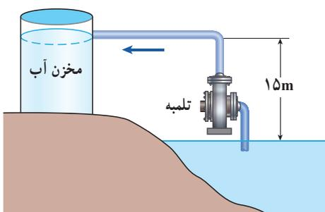
تلمبه‌ای با توان ورودی ۱۵kW در هر ثانیه ۷۰ لیتر آب دریاچه‌ای به چگالی  $1000 \text{ kg/m}^3$  را مطابق شکل روبه‌رو تا ارتفاع ۱۵ متری مخزنی می‌فرستد. بازده تلمبه چند درصد است؟
