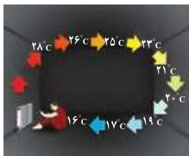
**شکل ۴-۲۸** گرم شدن هوای اتاق به روش همرفت
