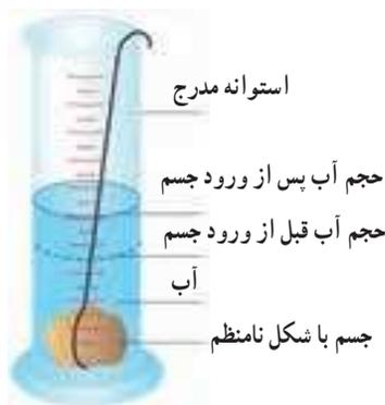
الف) جرم و حجم تعدادی جسم جامد را اندازه بگیرید. در صورتی که شکل جسم‌ها منظم باشد، ابعاد آنها را به کمک کولیس یا ریزسنج اندازه بگیرید. اگر جسم جامد شکل نامنظمی داشته باشد، از روشی که در شکل روبه‌رو نشان داده شده است حجم آن را اندازه بگیرید.
