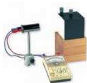
**شکل ۱۴-۳۳** درون مکعب لسلی، آب داغ می‌ریزند. تابش گرمایی از چهار وجه مکعب که رنگ‌های متفاوتی دارند، با هم فرق دارد.
