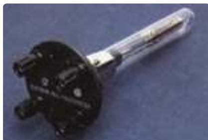
همان‌طور که در کتاب فیزیک ۱ دیدید دماسنجد مقاومت پلاتینی یکی از سه دماسنجد معیار برای اندازه‌گیری دماس است. از دماسنجد مقاومت پلاتینی می‌توان برای اندازه‌گیری دقیق دما در گستره دمایی حدوداً از  $۱۴ \text{ K}$  تا  $۱۲۳۵ \text{ K}$  استفاده کرد. اساس کار دماسنجد های مقاومت پلاتینی مبتنی بر تغییر مقاومت الکتریکی بادماس است. در این دماسنجد ها از پلاتین استفاده می‌کنند که تقریباً دچار خوردگی نمی‌شود و نقطه ذوب بالایی دارد.
