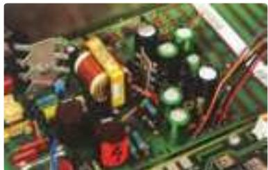
شکل ۱-۹ مدار یک تقویت‌کننده که شامل چند خازن است. برخی از خازن‌ها با پیکان مشخص شده‌اند.
