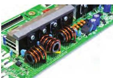
**شکل ۱۴-۱۰** برای به حداقل رساندن اثر القای متقابل در برخی از مدارهای الکتریکی، القاگرهای مجاور را به گونه‌ای قرار می‌دهند که سطح حلقه‌های مجاور را به طور عمود بر یکدیگر عمود باشد.
