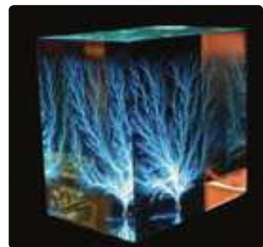
شکل ۱۴۵ نقش‌های لیچنبرگ. فروزیش الکتریکی باعث تشکیل مسیرهای رسانشی سرخس شکلی در دی الکتریک شده است.
