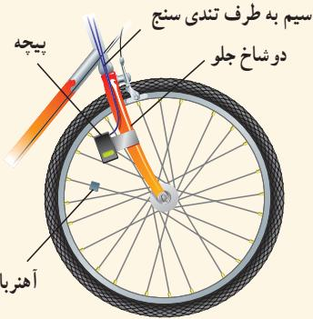
تندی سنج دوچرخه های مسابقه ای شامل یک آهنربای کوچک و یک پیچه است. آهنربای به یکی از پره های چرخ جلو و پیچه به دو شاخ فرمان متصل است (شکل رو به رو). دو سر پیچه با سیم های رسانا به نمایشگر تندی سنج (که در واقع نوعی رایانه کوچک است) وصل شده است. به نظر شما تندی سنج دوچرخه چگونه کار می کند؟ این موضوع را در گروه خود به گفت و گو بگذارید و نتیجه را به کلاس درس ارائه دهید.
