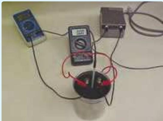
قانون ژول بیان می‌دارد گرمای تولید شده توسط جریان  $I$  ای عبوری از یک مقاومت  $R$  در مدت زمان  $t$  برابر با  $RI^2t$  است. این قانون را می‌توان به روش گرماسنجی با یک گرماسنج که در فیزیک دهم با آن آشنا شدید تحقیق کرد. اسباب این آزمایش در شکل نشان داده شده است. درباره چگونگی این آزمایش تحقیق کنید.
