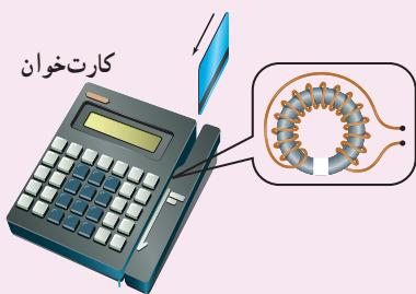
(ب) کشیدن کارت، جریان اندازی در پیچه دستگاه کارت خوان القا می کند.
