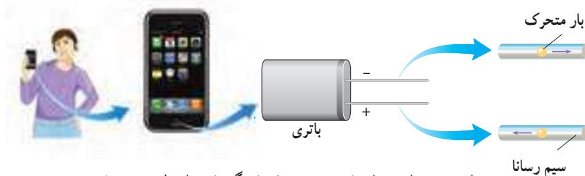
شکل ۱-۲ انرژی از باتری به صفحه نمایشگر تلفن، از طریق سیم‌های رسانایی که در آنها بارهای الکتریکی در جریان اند، منتقل می‌شود.
