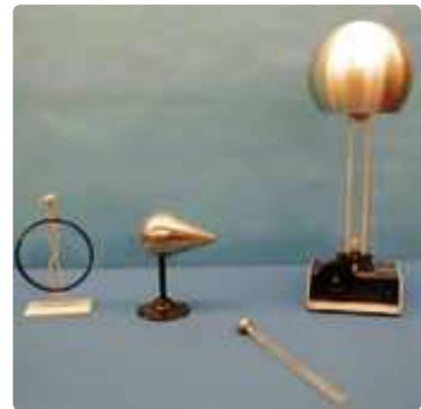
شکل ۳۳-۱ اسباب آزمایش چگونگی توزیع بار روی سطح خارجی یک جسم رسانای باردار
