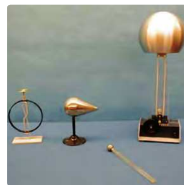
شکل ۱-۲۸ اسباب آزمایش چگونگی توزیع بار روی سطح خارجی یک جسم رسانای باردار
