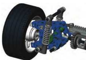
شکل ۲-۱۴ فنرهای به کار رفته در چرخ‌های خودرو
