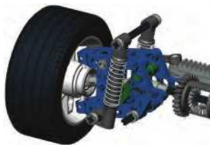
شکل ۲-۱۴ فنرهای به کار رفته در چرخ‌های خودرو
