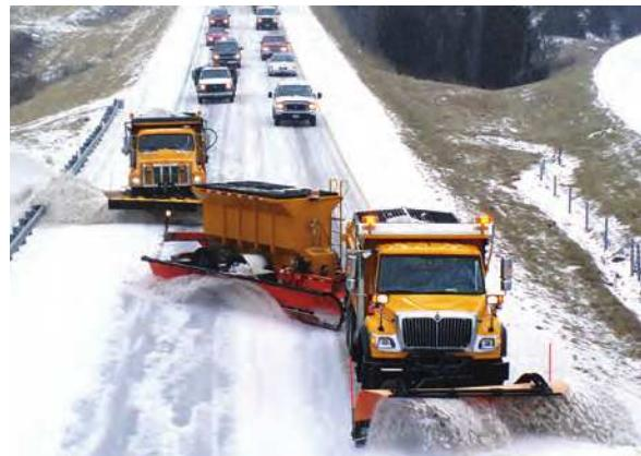
به کارگیری ماشین برفروب مجهز به جی‌پی‌اس جاده‌ای برای پاکسازی
