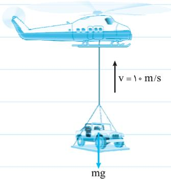
۵۹ هلی کوپتری که مطابق شکل اتومبیلی را حمل می کند، با تندی ثابت و در راستای قائم به سمت بالا در حرکت است. اتومبیل با تندی اولیه  $10 \text{ m/s}$  در ارتفاع  $150$  متری از هلی کوپتر جدا شده و سقوط می کند. اگر جرم اتومبیل  $1$  تن باشد و با تندی  $40 \text{ m/s}$  به زمین برخورد کند، کار نیروی مقاوم هوا روی اتومبیل چند ژول است؟ ( $g = 10 \text{ N/kg}$ )
