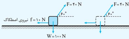
کار هر یک از نیروهایی را که در شکل رسم شده اند، محاسبه کنید.
