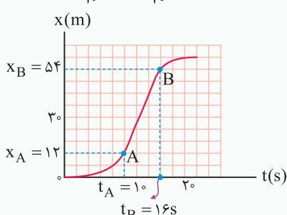
۶ در حرکت این متحرک، از لحظه  $t = 0$  تا  $t = 10$ ، سرعت متحرک در حال افزایش است (شبیه مماس ترسیمی بر نمودار در حال افزایش است)، در ادامه از  $A$  تا  $B$ ، نمودار مکان - زمان خط صاف بوده و سرعت متحرک ثابت است و در نهایت از  $B$  سرعت کاهش یافته و در نهایت به صفر می‌رسد. با توجه به این موضوع، بیشترین سرعت بین  $A$  تا  $B$  است و کافیست شبیه خط  $AB$  را بیابیم (هر یک از خانه‌های محور قائم معادل  $6 \text{ m}$  و هر یک از خانه‌های محور افقی معادل  $2 \text{ s}$  است):
