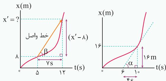
$$\text{سرعت متوسط} = v_{av} = \tan \beta = \frac{\text{ضلع مقابل}}{\text{ضلع مجاور}} = \frac{x' - 8}{7} = 4 \Rightarrow x' = 36 \text{ m}$$
