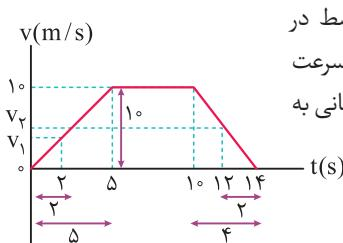
برای محاسبه شتاب متوسط در بازه زمانی  $t_1 = 2 \text{ s}$  تا  $t_2 = 12 \text{ s}$ ،  $t_1 = 2 \text{ s}$ ،  $t_2 = 12 \text{ s}$ ، ابتدا سرعت متحرك را در ابتدا و انتهای این بازه زمانی به کمک تشابه به دست می‌آوریم:
