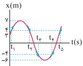
در صورت سؤال لحظاتی مدنظر است که متحرک در خلاف جهت محور  $x$  حرکت می‌کند، بنابراین باید سرعت متحرک و شیب خط مماس بر نمودار منفی باشد، بنابراین فقط لحظات  $t_2$  و  $t_3$  قابل قبول هستند و گزینه (۱) صحیح می‌باشد.
