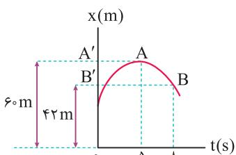
با توجه به نمودار مکان - زمان داده شده، متوجه در لحظه  $t_1 = 5s$  در مکان  $x_1 = 60m$  و در لحظه  $t_2 = 8s$  در مکان  $x_2 = 42m$  قرار دارد و داریم:
