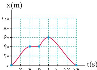
$4s \leq t < 6s$ : در این بازه، متحرک در مکان  $x = 40m$  استاده و حرکت نمی‌کند. دقت شود که باگذشت زمان، مکان متحرک عوض نمی‌شود و  $x$  ثابت است.
