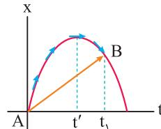
از طرف دیگر شیب خط مماس بر نمودار در یک لحظه، بیانگر سرعت لحظه‌ای متحرک در آن لحظه است. همان‌طور که می‌بینید، از شروع حرکت تا لحظه  $t'$  شیب خط مماس و سرعت لحظه‌ای مثبت و از لحظه  $t_1$  شیب خط مماس و سرعت لحظه‌ای منفی می‌باشد. بنابراین سرعت لحظه‌ای و سرعت متوسط ابتدا هم جهت و سپس در خلاف جهت هم هستند.
