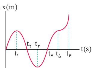
۲ در بازه زمانی  $t_4$  تا  $t_5$ ، متحرک در جهت محور  $x$  از مبدأ دور می‌شود.
