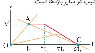
$$\begin{cases} OA: \text{شبیه خط } a_{av,OA} = \frac{v'}{t_1} \\ AC: \text{شبیه خط } a_{av,AC} = -\frac{v'}{4t_1} \end{cases} \Rightarrow |a_{av,OA}| > |a_{av,AC}|$$
