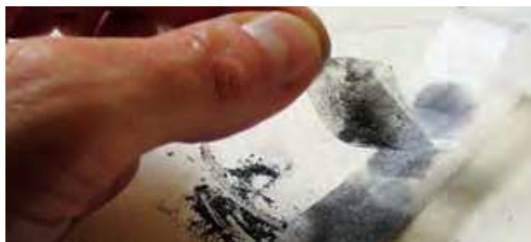
شکل ۴- تهیه گرافن با استفاده از نوار چسب
