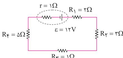
**مثال ۶** در مدار شکل زیر، توان خروجی باتری و توان مصرفی مقاومت  $R_1$  را حساب کنید.
