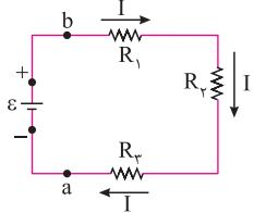
در بستن متواالی مقاومت‌ها، از همه مقاومت‌ها جریان یکسانی عبور می‌کند. مقاومت معادل ( $R_{eq}$ ) به مقاومتی گفته می‌شود که می‌توانیم تمام مقاومت‌ها را با آن جایگزین کنیم، به طوری که خلی در کار مدار ایجاد نشود. در مقاومت‌های متواالی مقاومت معادل از رابطه زیر محاسبه می‌شود.
