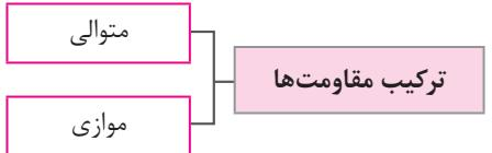
به هم بستن **متواالی مقاومت‌ها**: متواالی به معنای بسته شدن مقاومت‌ها یکی پس از دیگری است، به طوری که هیچ انشعابی بین آن‌ها وجود نداشته باشد (شکل زیر).
