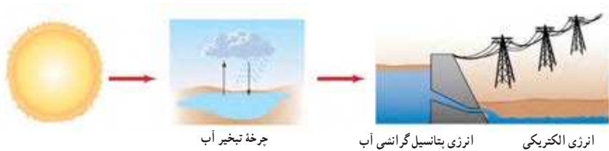
شکل ۱۲. انرژی پتانسیل گرانشی آب پشت سد توسط توربین‌ها و مولدها به انرژی الکتریکی تبدیل می‌شود.
