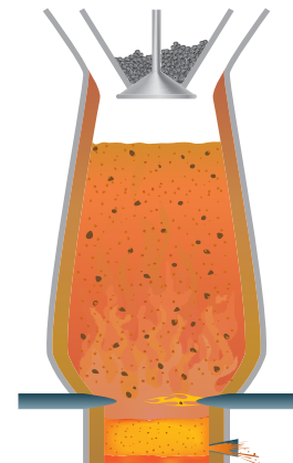
(ب) گرم‌دادن مخلوط سنگ آهن، کربن و سنگ آهک در کوره (ت) تولید ورقه‌های فلز آهن
