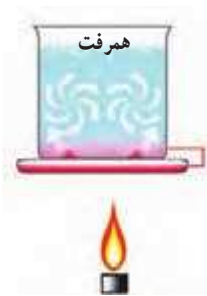
شکل ۸. آب گرم شده به سمت بالا حرکت می‌کند و آب سرد جای آن را می‌گیرد.
