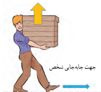
شکل ۴. وقتی نیرو بر جهت جابه‌جایی عمود باشد، کاری انجام نمی‌دهد.
