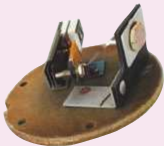
شکل ۲-۳ اجزای داخلی یک مدار کنترل کننده نوری، که در نوعی از چراغ‌های روشنایی خیابان‌ها استفاده می‌شود.
