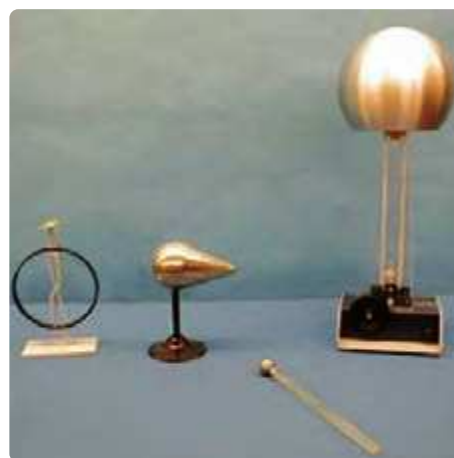
شکل ۳۳-۱ اسباب آزمایش چگونگی توزیع بار روی سطح خارجی یک جسم رسانای باردار
